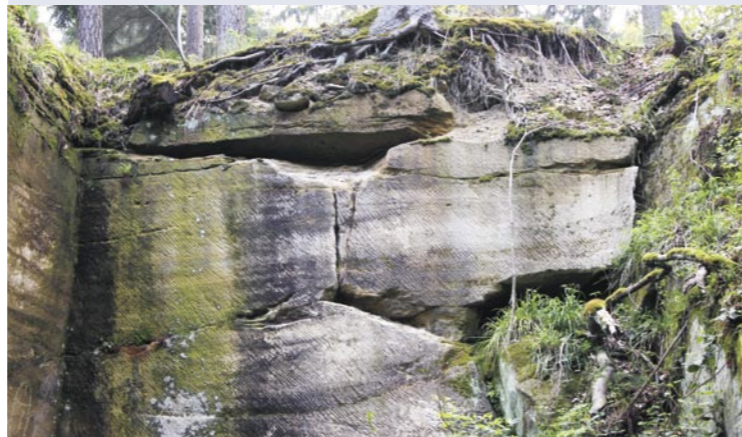
► Aufgelassener Steinbruch im Arzloch. Deutlich sind die Bearbeitungsspuren an den Bruchwänden zu erkennen. Da sich der Sandstein im bergfrischen Zustand verhältnismäßig gut bearbeiten ließ (er härtet beim Trocknen aus), glättete man die Steinbruchwände bevor man den Abbau z.B. saisonbedingt ruhen ließ.
