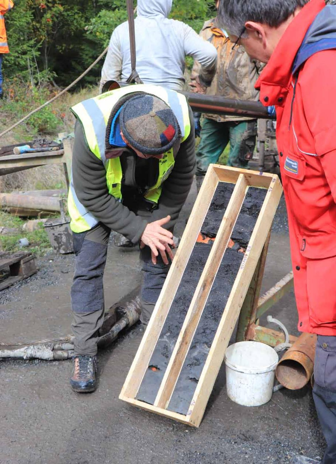
◀ *Dr. Ernst Kroemer (links) und Dr. Johann Rohrmüller (rechts) begutachten einen Bohrkern der Bohrung Rohrloh. Der PE-Liner wurde in der Mitte geteilt.*
